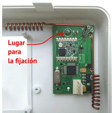
Figura 24. Receptor de radio Ajax «uartBridge» en el cuerpo del dispositivo
