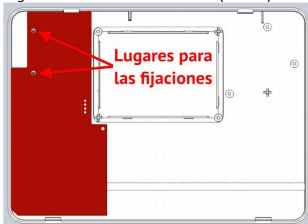
Figura 17. Módulo de radio “Lun-R” en el cuerpo del Panel de control
