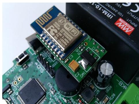
Figura 26. Instalación del módulo “W25M”
