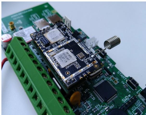
Figura 21. Módulo de radio “L25-Crow rev.2” en placa del PC
