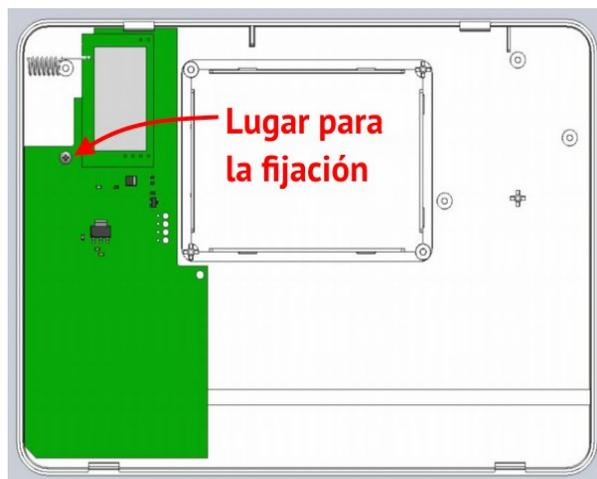
Figura 22. Módulo de radio “L25-Crow rev.3” en el cuerpo del dispositivo
